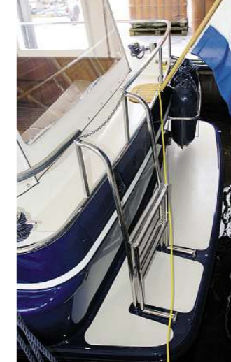
Gehebares Laufdeck am Achterschiff und 60 cm tiefer Steg
