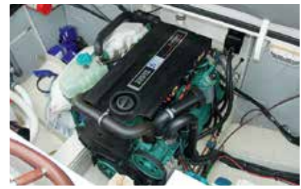
Der fünfzylindrige Turbodiesel von Volvo Penta leistet 140 kW (190 PS)
