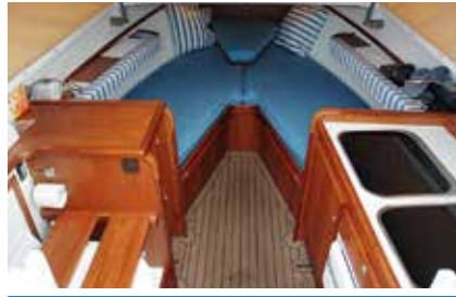
Die Bugkabine mit V-Doppelkoje, Pantryblock und Sanitärbereich
